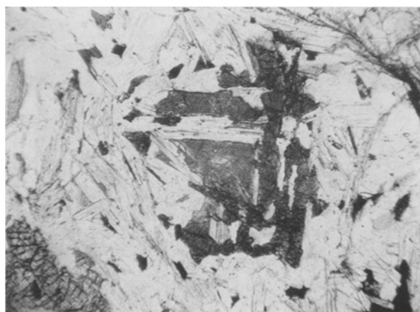
Abb. 7. Umwandlung von Granat in ein regelloses Gemenge bestehend aus: Muskovit + Biotit + Quarz + Erz. Disthen I ist am Rand der Abb. deutlich zu erkennen.
